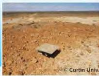
ウーメラ砂漠に設置されたインフラサウンドセンサー
