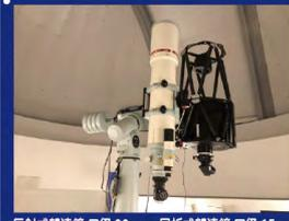
反射式望遠鏡 口径 30cm、屈折式望遠鏡 口径 15cm
